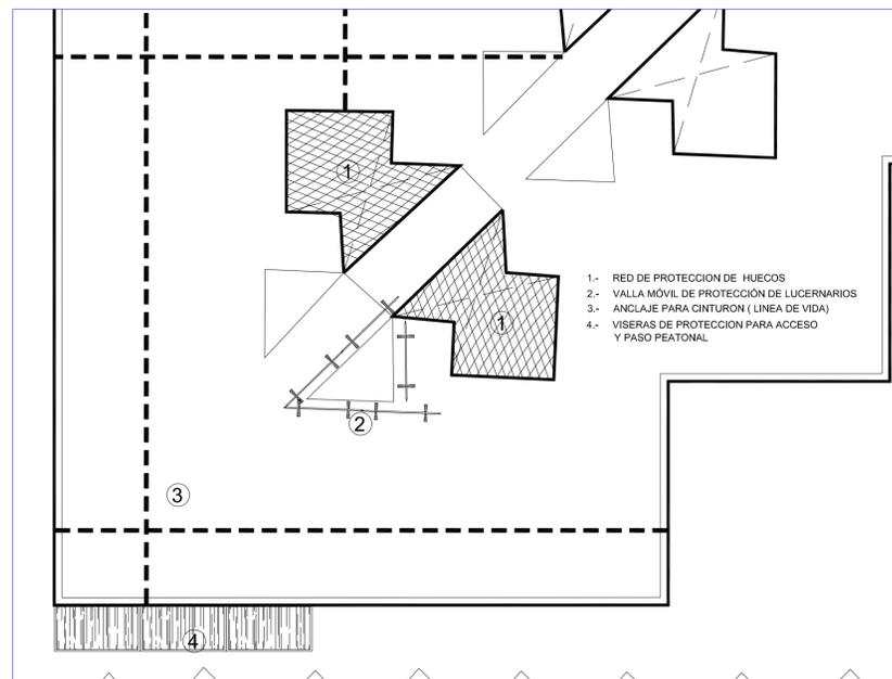
TODOS LOS ELEMENTOS DE SEGURIDAD INDICADOS PARA ZONAS SINGULARES SE REPETIRAN EN EL CONJUNTO DE LAS OBRAS
