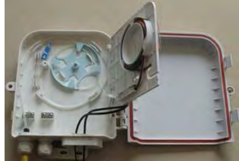
Caja mural de empalme y reparto
