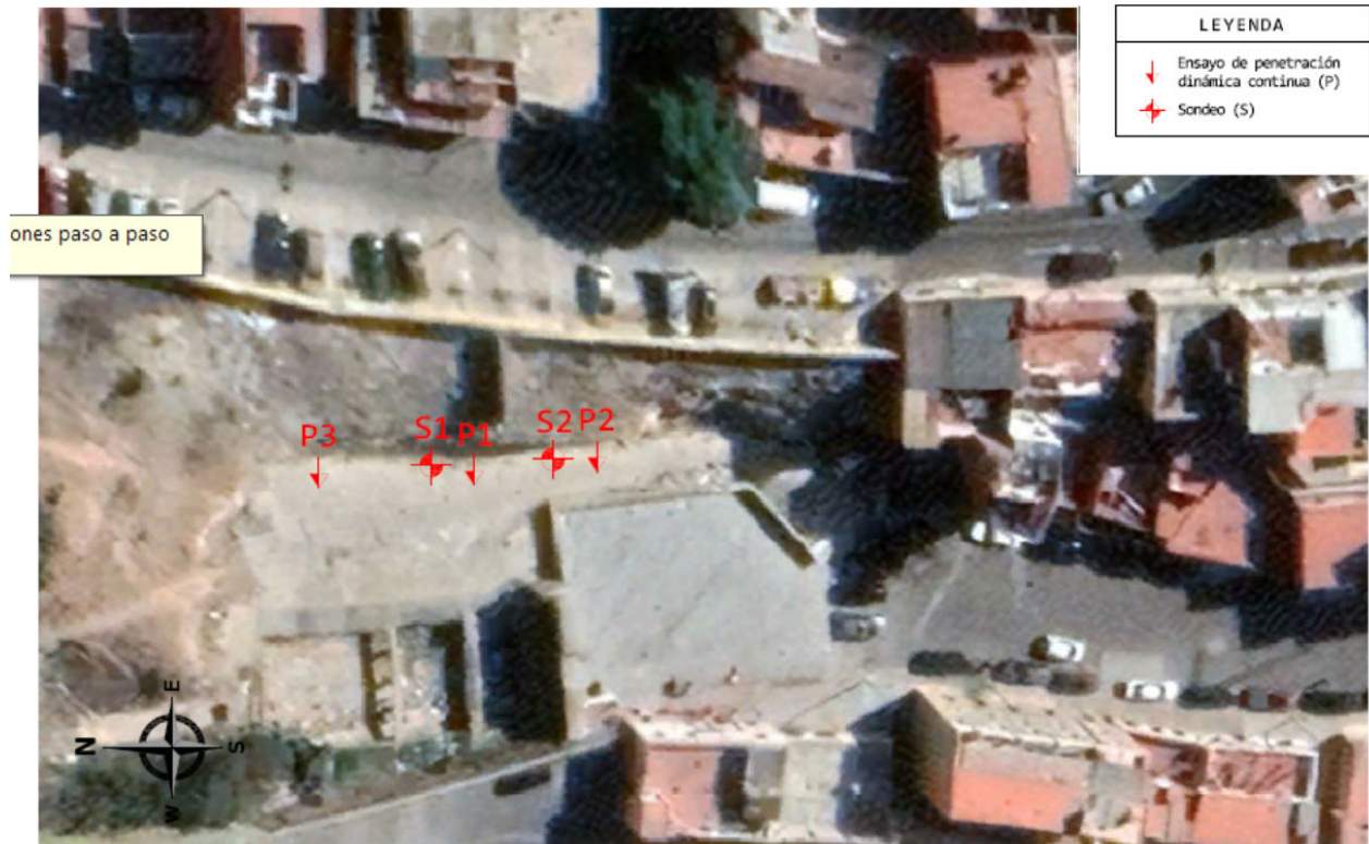
Figura nº 7: Emplazamiento de las exploraciones geotécnicas.
